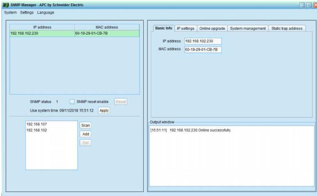
3. SNMP 관리자 인터페이스에서 IP 설정, 온라인 업그레이드, 암호 관리 및 정적 트랩 주소 설정을 수정할 수 있습니다. 어떤 상황에 대해서도 암호를 입력해야 합니다. 기본 암호는 12345678 입니다.
