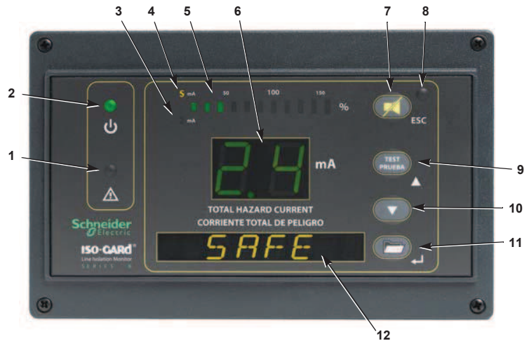
Figura 8: Pantalla en el panel frontal—Condición normal
