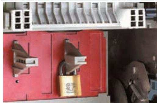
**Schneider Electric** propone obturadores aislados que bloquean el acceso de forma automática a las abrazaderas de conexión cuando el aparato está en la posición "retirado" o "en prueba" (grado de protección: IP20). Cuando se extrae el aparato de su marco, no se puede tener acceso a las piezas en tensión.
