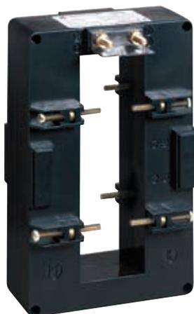
El papel principal del transformador de corriente es la reducción del valor de corriente que ha de ser medido a un valor que sea aceptable para la aparatenta de medida (normalmente entre 1 y 5 A).
