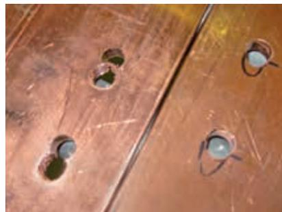
**✗ Las barras deben desecharse si se producen errores de perforación**
