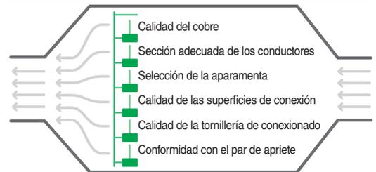
Al igual que el peaje de una autopista, donde el flujo de vehículos se regula y optimiza mediante el número de cabinas abiertas, la disipación de calor por conducción en un cuadro de distribución depende de la conformidad con todas las recomendaciones relacionadas.
