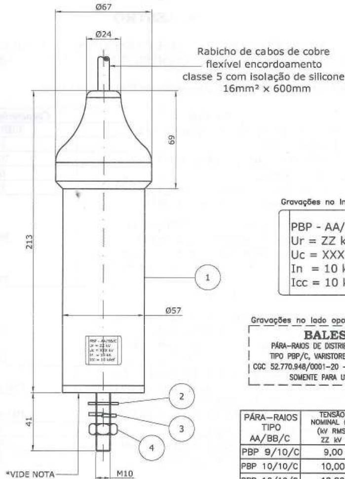
Rabicho de cabos de cobre flexível encordoamento classe 5 com isolamento de silicone 16mm<sup>2</sup> x 600mm
